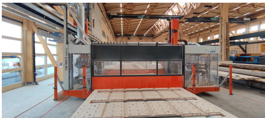
Die TW-Mill E ist konzipiert für die Bearbeitung von Element- und Holzrahmenbau. (Foto: TechnoWood AG)
